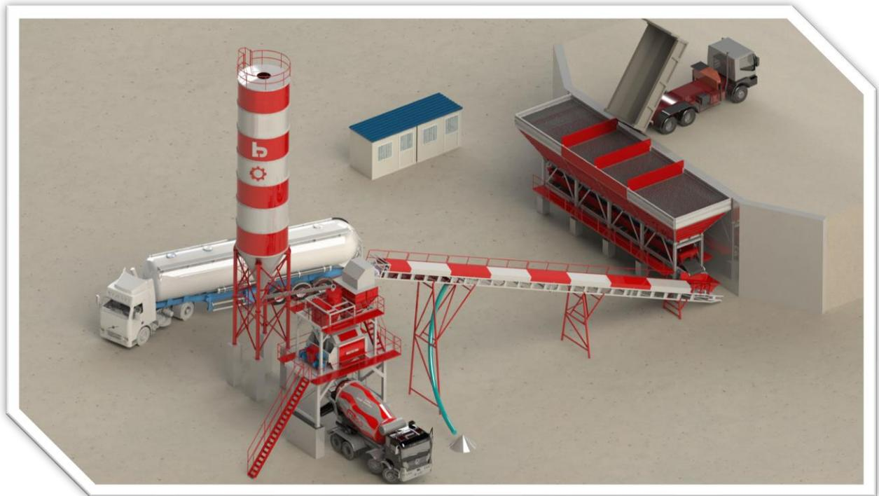
بچینگ پلانت های ثابت طراحان جهت تولید بتن آماده در ظرفیتهای مختلف طراحی و تولید میشوند که خروجی بتن به صورت تر و خشک میتواند باشد که در حالت خشک مواد اولیه بتن قبل از اختلاط با آب وارد تراک میسر (ماشین حمل) شده و تا محل تخلیه، عمل آوری میگردد که به این سیستم بچینگ پلانت خشک گفته میشود.
